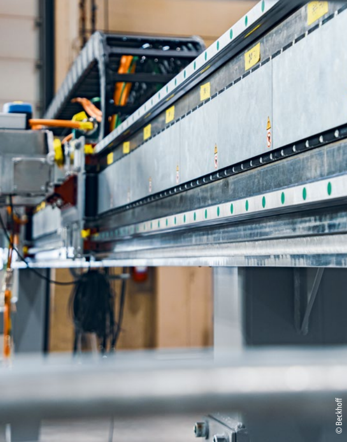
Für Dynamik und Präzision sorgen die hochdynamischen Linearmotoren AL8000.
