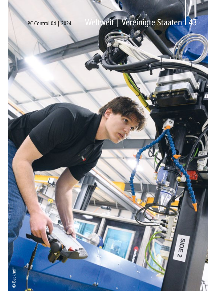
Mit der Hot-Connect-Fähigkeit von EtherCAT kann das End-of-Arm-Tooling der Roboter für ein anderes Prüfverfahren schnell umgerüstet und die Flexibilität erhöht werden.
