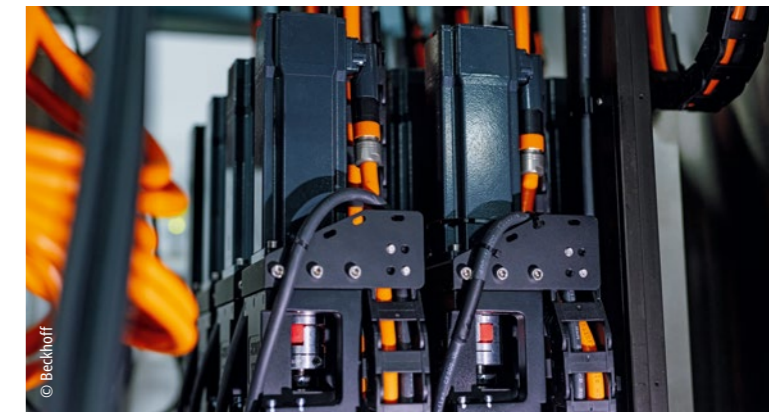
Mit höchster Präzision steuern Beckhoff Servomotoren AM8100 die Kugelumlaufspindeln zum Heben und Senken des Werkzeugs für das elektrochemische Abtragen.
