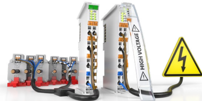
Bei der verteilten Leistungsmessung reicht durch die Distributed Clocks von EtherCAT nur eine Messklemme EL3443 aus, um zusammen mit beliebig vielen im Netz verteilten Messklemmen EL3446 eine detaillierte und qualitativ hochwertige Leistungserfassung zu realisieren.
