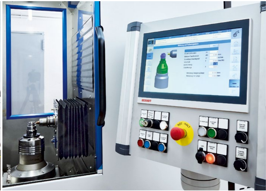
Die Anwahl der Werkzeuge und Aufträge erfolgt über ein Multitouch Control-Panel CP2916, das mit dem Embedded-PC CX5140 im Schaltschrank verbunden ist.
