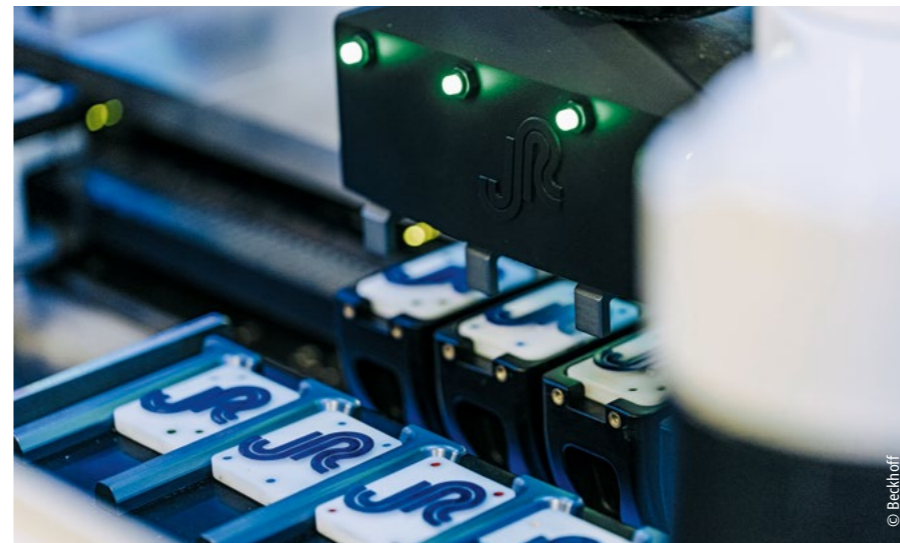
Die XTS-Mover können synchron oder asynchron arbeiten, was bei der gleichzeitigen Bearbeitung mehrerer Teile – z. B. wie hier in einer Vierfach-Station – von großem Vorteil ist.
