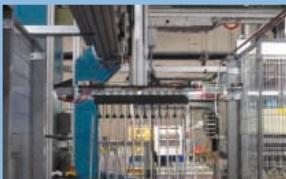
Der Roboter, angesteuert von zwei Beckhoff Servoverstärkern, verlegt die Kabel innerhalb der Spritzstraßen.
