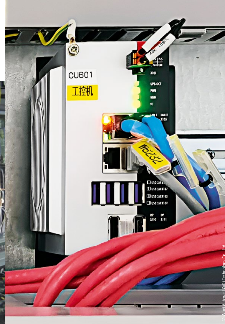
Der offene und flexible Ultra-Kompakt-Industrie-PC C6030 steuert eine Vielzahl von Fremdgeräten, die als Slaves im EtherCAT-Automatisierungsnetzwerk agieren.
