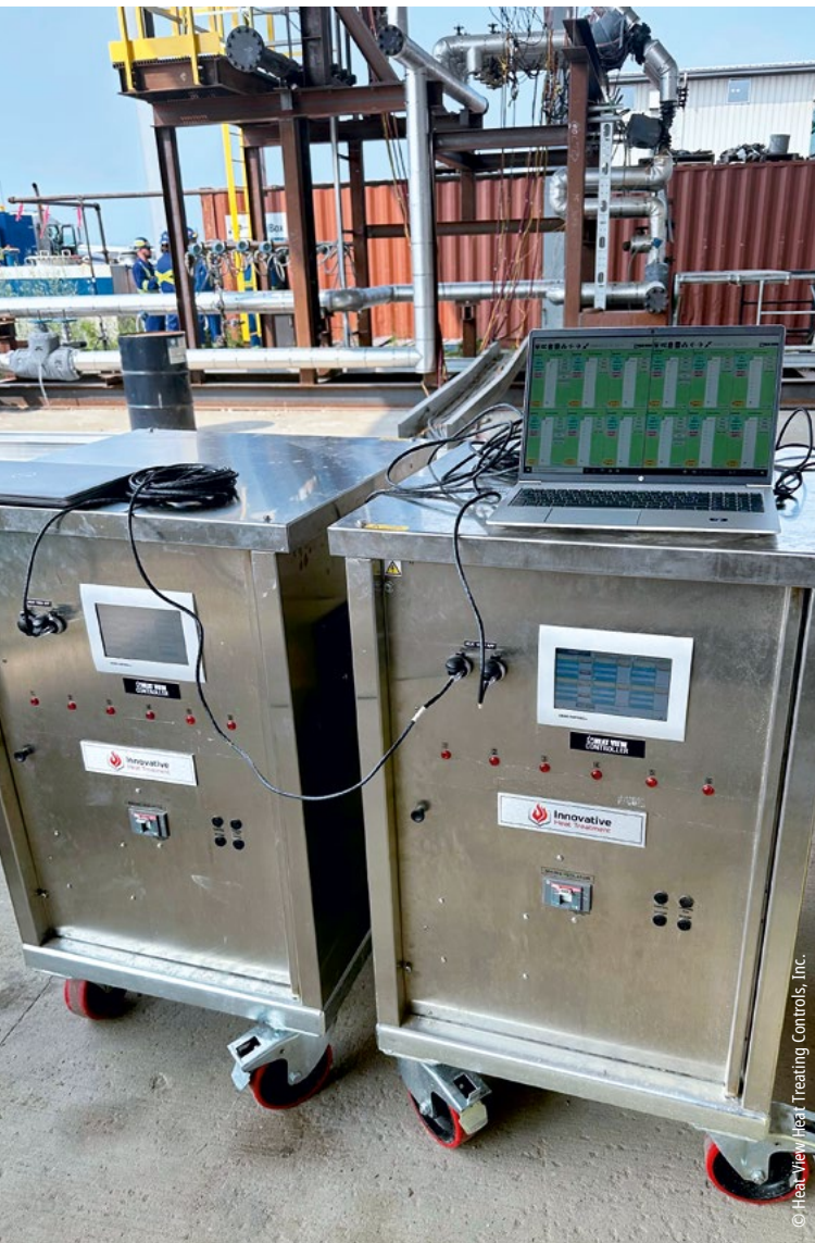
In der integrierten Variante wird das Steuerungssystem Heat View über den 7-Zoll-Touchscreen des Einbau-Panel-PCs CP6606 bedient.
