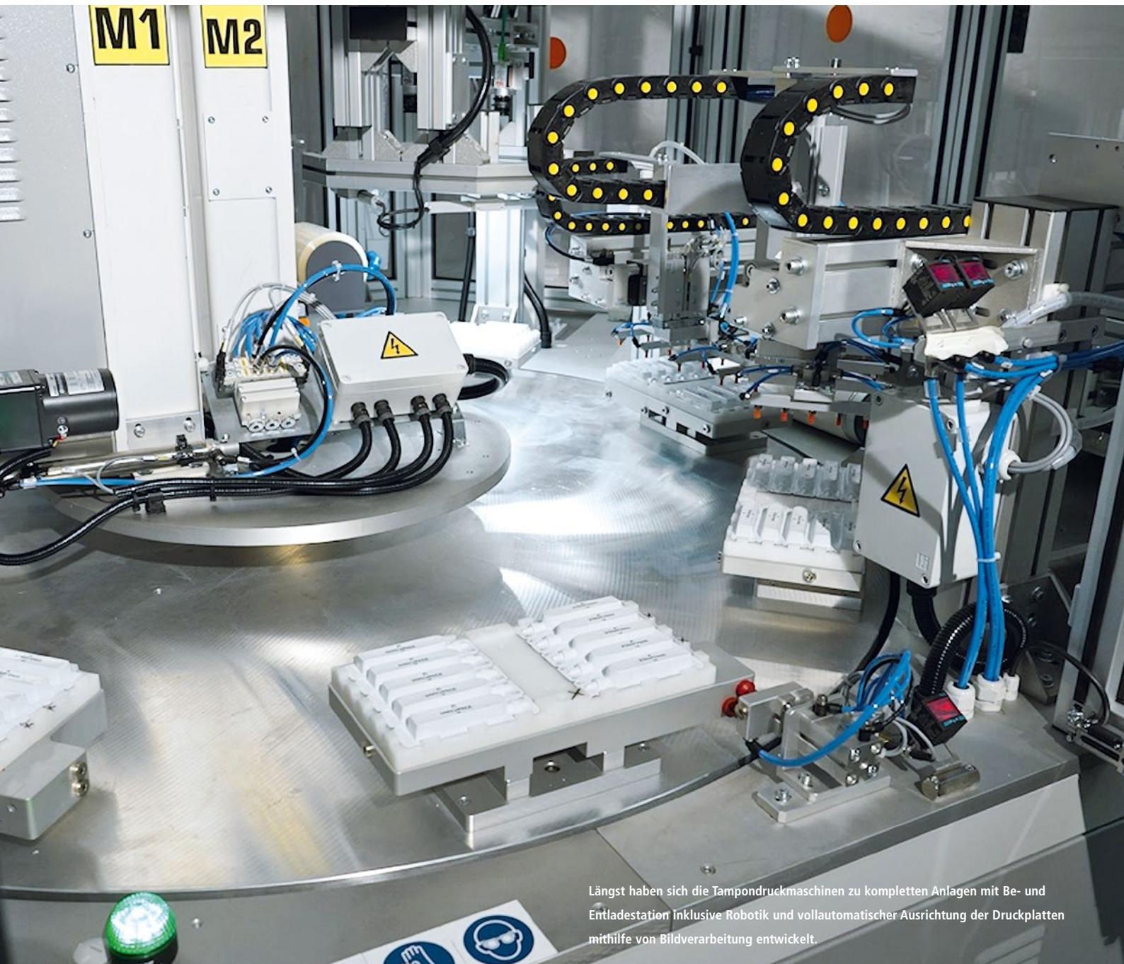
Längst haben sich die Tampondruckmaschinen zu kompletten Anlagen mit Be- und Entladestation inklusive Robotik und vollautomatischer Ausrichtung der Druckplatten mithilfe von Bildverarbeitung entwickelt.
