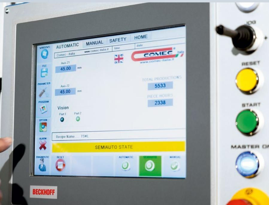
Die offene PC-basierte Steuerungsarchitektur ermöglicht u.a. die Integration der Anlagen in die Kundennetzwerke und eine umfassende Diagnose.
