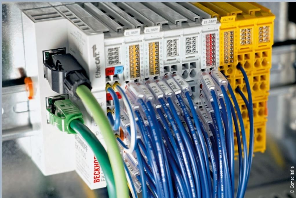
Die EtherCAT-I/O-Inseln der Maschinenmodule liefern sowohl Standard- als auch Sicherheitssignale an die zentrale Maschinensteuerung.
